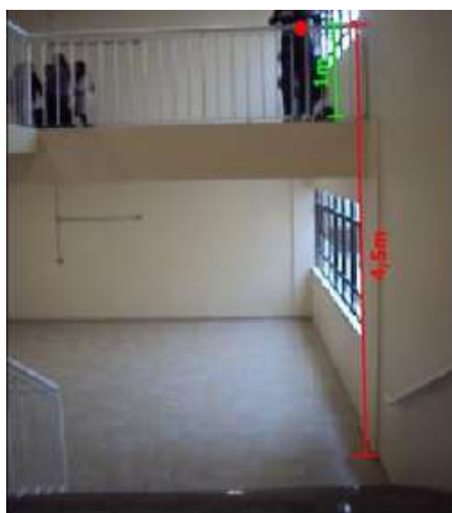
Figura 2: Medida do valor da aceleração da gravidade utilizando o filme de um objeto caindo.
