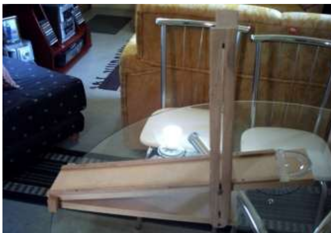
Figura 4: Aparato para determinar o momento de inércia de uma esfera.
