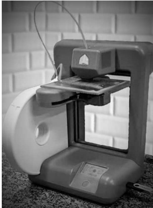
Figura 6. Imagem da impressora Cube 2 (3D Systems) utilizada na confecção dos modelos dos microrganismos deste estudo, iniciando a impressão do suporte de um modelo.
