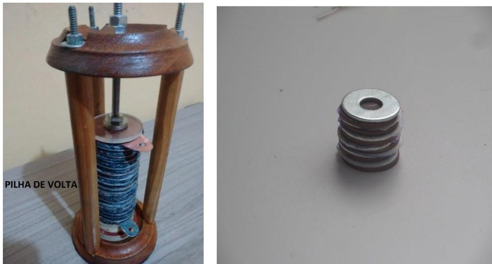
Figura 2: À esquerda está a réplica da pilha de Volta. À direita temos a pilha elaborada pelos alunos a partir do relato de Volta, usando moedas, arruelas e papel umedecido em água salgada. Fonte: autores.
